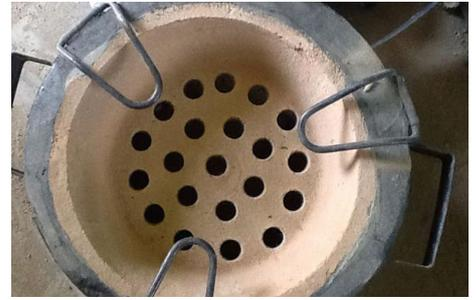
Der keramische Einlass des Kochers erhöht die Verbrennungseffizienz und speichert Wärme.
